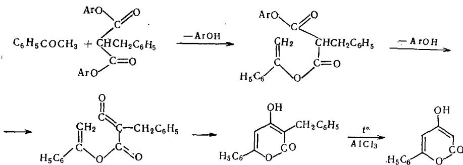
Этой реакцией из различных жирно-ароматических<sup>99</sup> и циклических<sup>100</sup> кетонов были получены (после дебензилирования) 4-оксипираны-2 со свободным 3-положением<sup>53</sup>. Этим же методом, исходя из  $\beta$ -ацетилпиридина, был получен с хорошим выходом анибин [4-метокси-6-( $\beta$ -пиридил)-пиран-2]<sup>101</sup>:
