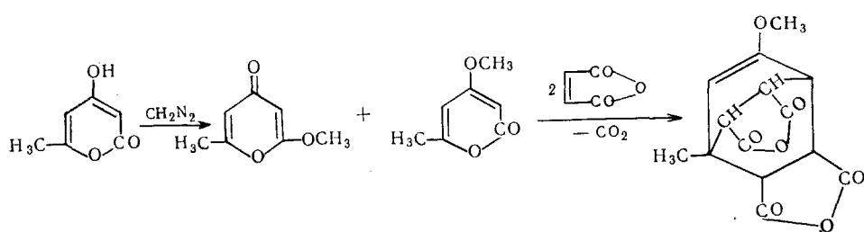
Описано применение ацетилендикарбонового эфира<sup>59, 312, 313</sup> в качестве диенофилла в реакции с пиронами-2; реакция сопровождается выделением углекислого газа и приводит к образованию соответствующих эфиров фталевой кислоты:
