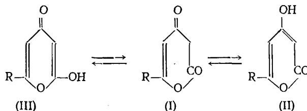
Действительно, как это показано с помощью ИК и УФ спектров, пирандионы (пирононы) существуют в зависимости от заместителей, агрегатного состояния и растворителя в форме либо 4-оксипирона-2 (II), либо 2-оксипирона-4 (III), либо в виде равновесной смеси (II) и (III) <sup>57–59</sup>.
