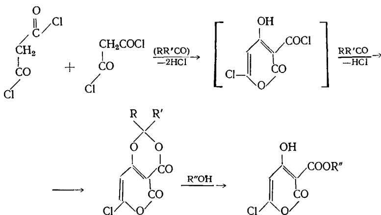
При конденсации малонилдихлорида с ацетилацетоном образуется изомерный дегидрацетовой кислоте пиронон, содержащий ацетильную группу в положении 5<sup>84</sup>. Несимметричные  $\beta$ -дикетоны дают при этих превращениях изомер, соответствующий предпочтительному направлению енолизации<sup>84</sup>:
