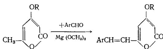
Осуществленные в последнее время реакции электрофильного замещения пиронов-2 позволяют получать производные пиронов-2, имеющие в положении 3 функциональный заместитель<sup>230–235</sup>:
