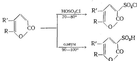
где  $R=R'=CH_3$ ;  $R=CH_3$ ,  $R'=C_3H_7, C_4H_9$ .
