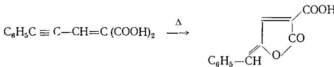
Циклизация ениновых кислот лежит в основе предложенного недавно метода получения 4,6- и 3,4,6-замещенных пиронов-2 из эфиров 3-оксиалкин-4-овых кислот<sup>155</sup>:
