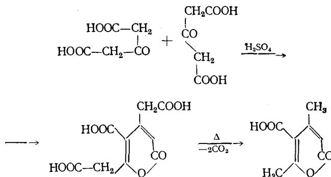
При нагревании до 160—170° с концентрированной серной кислотой изодегидрацетовая кислота декарбоксилируется в 4,6-диметилпирон-2<sup>23,36</sup>.
