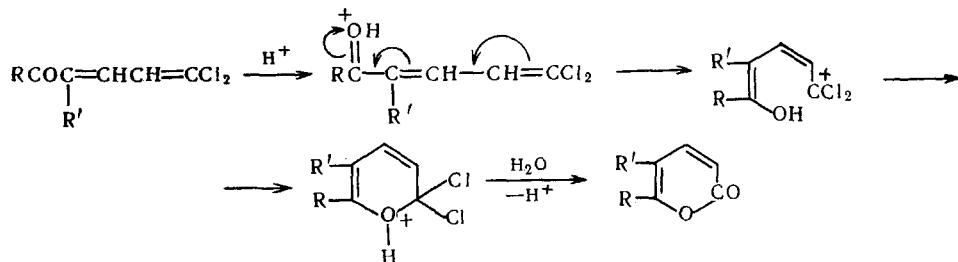
В этой реакции вместо  $\beta,\beta$ -дихлоракролеина могут быть применены хлорацеталь  $\text{CCl}_2=\text{CH}-\text{CHClOR}$  или теломер  $\text{CCl}_3\text{CH}_2\text{CHClOR}$ <sup>181</sup>, промежуточно образующиеся при синтезе  $\beta,\beta$ -дихлоракролеина.
