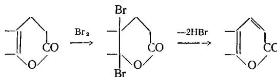
Реакция может служить препаративным методом получения 5,6-циклоалкано- и 5,6-диалкил-(алкиларил)-пиранов-2<sup>213, 215, 216</sup>.
