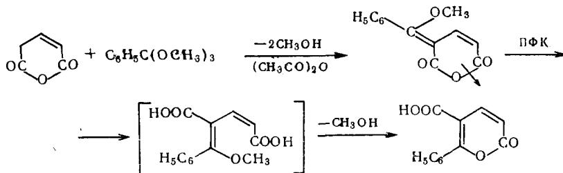
При действии ацилирующих агентов на  $\beta$ -метил- и  $\beta$ -арилглутаконовые ангидриды получены 5-ацилпроизводные, из которых легко образуются 4-метил-6-алкил-<sup>128-131</sup>, 6-алкил-4-арил-<sup>132, 133</sup> и 4,6-диарилпироны-2<sup>134</sup> (с раскрытием цикла и перециклизацией с участием ацильной группы)<sup>128</sup>:
