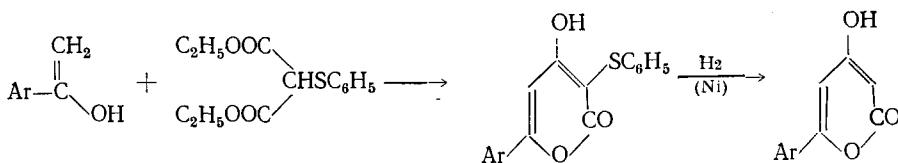
Этим путем удалось получить 4-оксипаракотоин [Ar=3',4'-(CH<sub>2</sub>O<sub>2</sub>) C<sub>6</sub>H<sub>3</sub>]<sup>104, 105</sup>.
